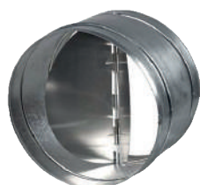
ОБРАТНЫЙ КЛАПАН Для избежания противотока воздуха. Материал: оцинкованная / нержавеющая сталь. Размеры: диаметр до 315 мм.
